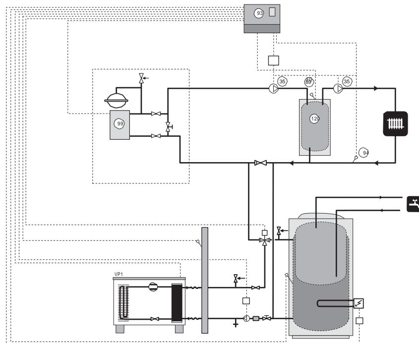
V případě, že objem systému v radiátorovém okruhu je nižší než 20 l/kW (výkon tepelného čerpadla při 7/45 °C) a/nebo není regulováno tlumení průtoku v radiátorech, nádrž UKV se instaluje jako prostředek na zvýšení objemu a průtoku. Spojka T se musí umístit co nejbližše nádrži UKV.
