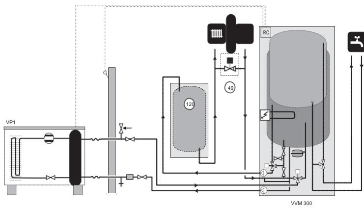
В случае, если объем системы отопления менее 20 л/кВт (мощность теплового насоса при 7/45°C) и /или не регулируется гашение проточности, бак UKV (120) устанавливается как средство для увеличения объема и проточности. Закройте все неиспользуемые элементы подключения. Если грозит опасность возможной нулевой проточности, необходимо установить автоматический перепускной клапан.
