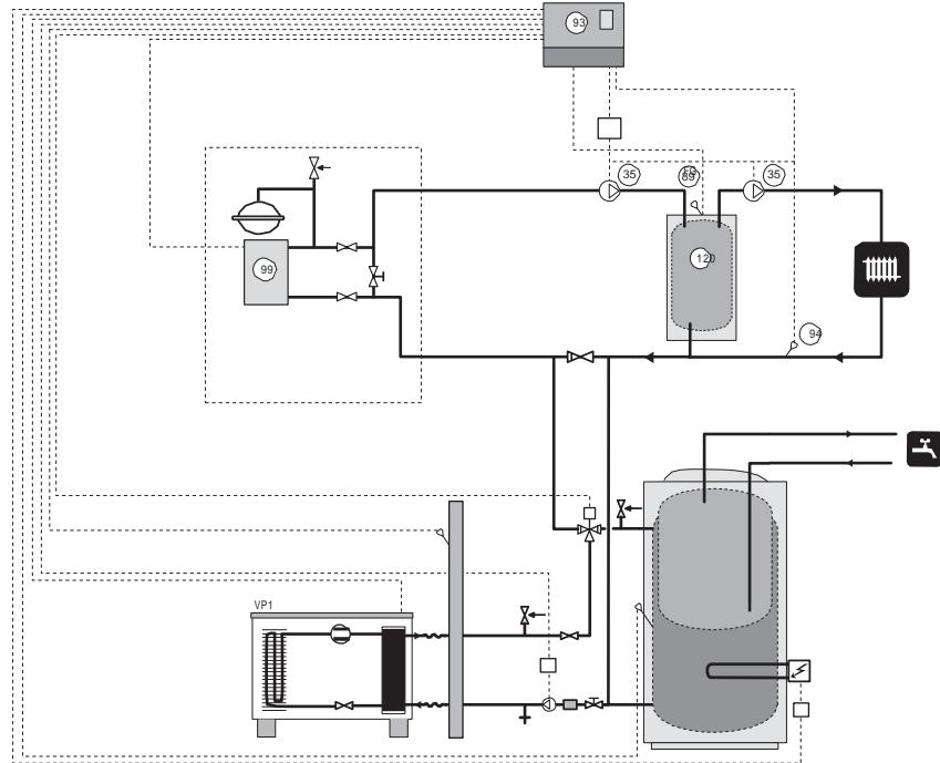
Wenn das Systemvolumen im Heizkörperkreis unter 20 l/kW (Wärmepumpenleistung bei 7/45 °C) liegt und/oder der Heizkreisfluss unkontrolliert gedrosselt wird, wird ein UKV-Speicher zur Volumen- und Flussvergrößerung installiert. Die T-Rohrkupplung ist so nah wie möglich am UKV-Speicher zu platzieren.
