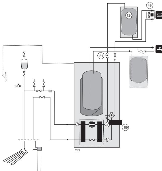
Dieser Anschluss wird verwendet, wenn das Systemvolumen nicht ausreicht oder um Wärmeengpässe im Heizsystem zu reduzieren. Verwenden Sie Anschlüsse über Kreuz (z. B. links oben und rechts unten). Nicht verwendete Anschlüsse müssen mit Stopfen verschlossen werden. Beim Risiko eines potentiellen Nullvolumenstroms muss ein druckgesteuertes Überströmventil installiert werden.
