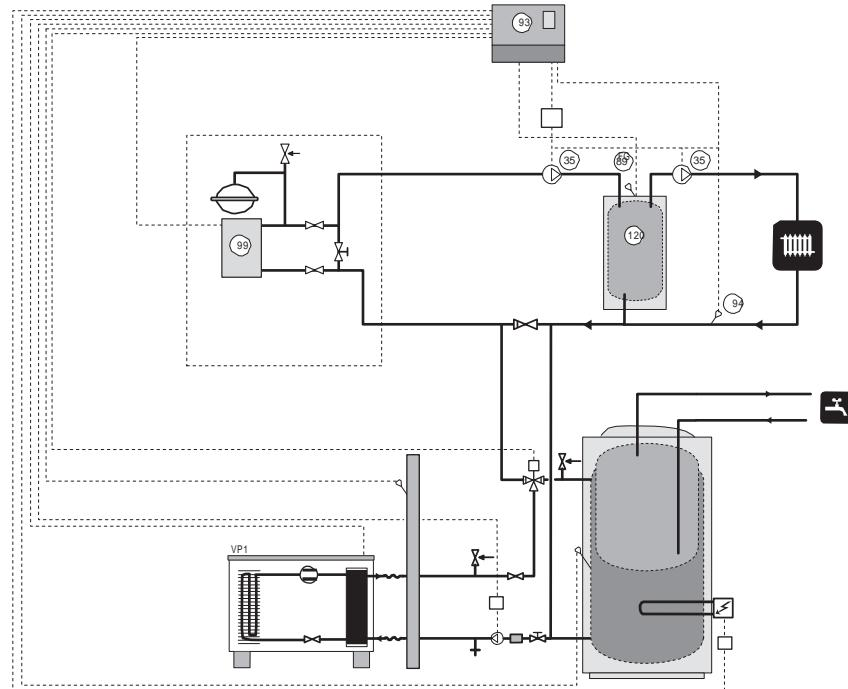
В случае, если объем в системе контура радиаторов отопления менее 20 л/кВт (мощность теплового насоса при 7/45 °C) и/или не регулируется уменьшение проточности в радиаторах отопления, бак UKV устанавливается как средство для увеличения объема и проточности. Соединитель Т должен быть расположен как можно ближе к баку UKV.
