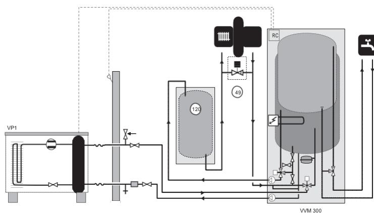
V případě, že objem systému v topném systému je nižší než 20 l/kW (výkon tepelného čerpadla při 7/45°C) a/nebo není regulováno tlumení průtoku, nádrž UKV (120) se instaluje jako prostředek na zvýšení objemu a průtoku. Uzavřete všechny přípojky, které se nepoužívají. Pokud hrozí nebezpečí možného nulového průtoku, musí se nainstalovat automatický přepouštěcí ventil.
