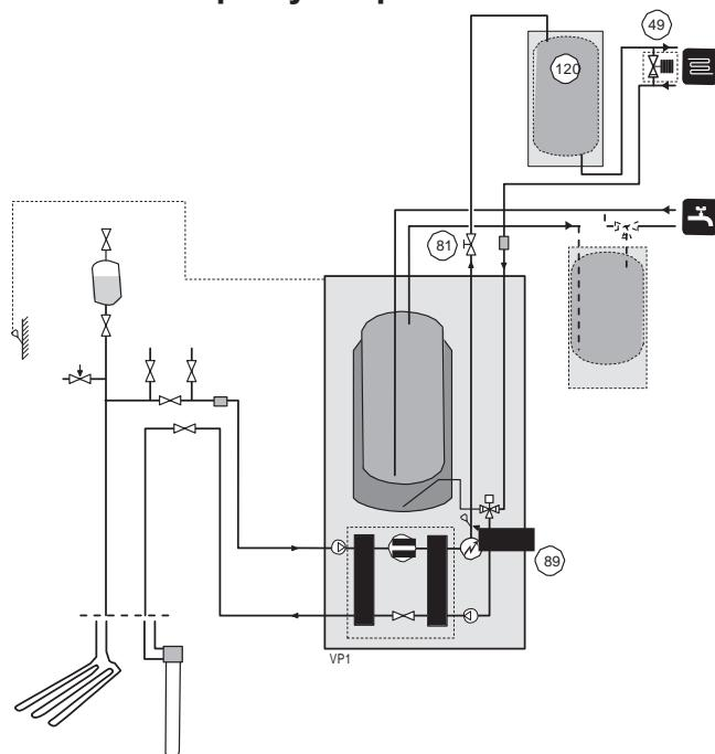
Toto zapojenie sa používa v prípade nedostatočného objemu systému alebo za účelom obmedzenia tepelných špičiek vo vykurovacom systéme. Nádrž UKV sa inštaluje za účelom vylúčenia tepelných špičiek vo vykurovacom systéme. Zvoľte diagonálne prípojky (napr. vľavo hore a vpravo dole). Uzavrite všetky prípojky, ktoré sa nepoužívajú. Pokiaľ hrozí nebezpečenstvo možného nulového prietoku, musí sa nainštalovať automatický prepúšťací ventil.
