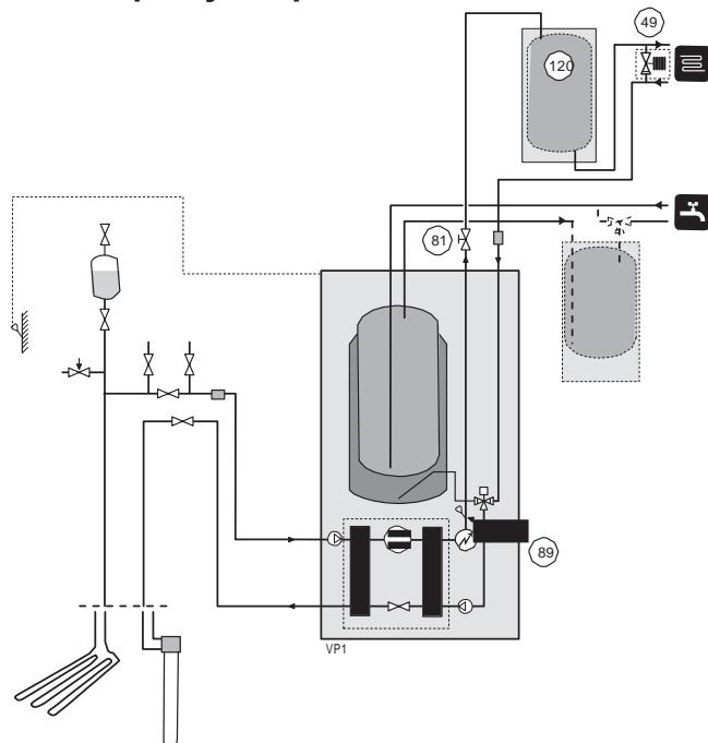
Toto zapojení se používá v případě nedostatečného objemu systému nebo za účelem omezení tepelných špiček v topném systému. Nádrž UKV se instaluje za účelem vyloučení tepelných špiček v topném systému. Zvolte diagonální přípojky (např. vlevo nahore a vpravo dolu). Uzavřete všechny přípojky, které se nepoužívají. Pokud hrozí nebezpečí možného nulového průtoku, musí se nainstalovat automatický přepouštěcí ventil.
