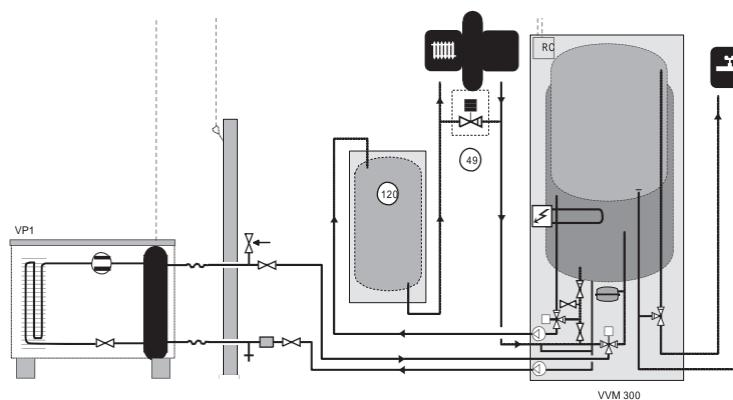
Wenn das Systemvolumen im Heizungssystem unter 20 l/kW (Wärmepumpenleistung bei 7/45 °C) liegt und/oder das Heizungssystem unkontrolliert gedrosselt wird, muss ein UKV-Speicher (120) zur Volumen- und Flussvergrößerung installiert werden. Nicht benötigte Anschlüsse müssen mit Stopfen verschlossen werden. Beim Risiko eines potentiellen Nullvolumenstroms muss ein druckgesteuertes Überströmventil installiert werden.
