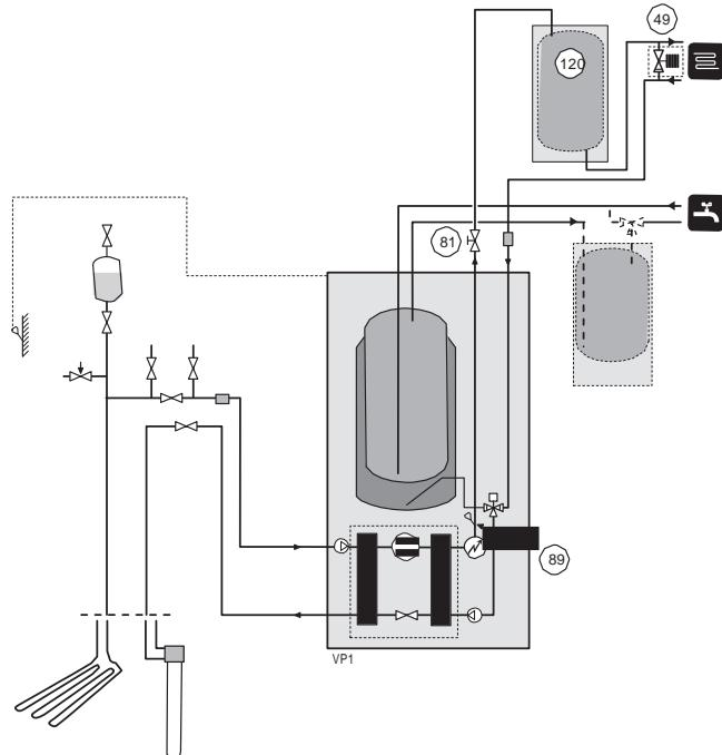
Это подключение применяется в случае недостаточного объема системы или с целью ограничения температурных пиков в системе отопления. Бак UKV устанавливается с целью исключения температурных пиков в отопительной системе. Выберите диагональные элементы подключения (например влево вверху и вправо внизу). Закройте все неиспользуемые элементы подключения. Если грозит опасность возможной нулевой проточности, необходимо установить автоматический перепускной клапан.
